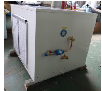
室內機 (耐壓防爆型)
